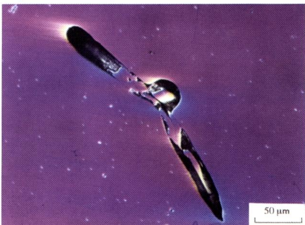
Fig. 11 : la chaîne opératoire du fer en sidérurgie directe : l'épuration, replis en cours d'écrasement ; scorie provenant de la forge F104 de Blessey-Salmaise, (cliché Ph. FLUZIN).
