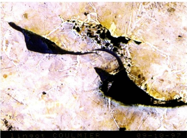
Fig. 11 : la chaîne opératoire du fer en sidérurgie directe : l'épuration, replis en cours d'écrasement ; scorie provenant de la forge F104 de Blessey-Salmaise, (cliché Ph. FLUZIN).
